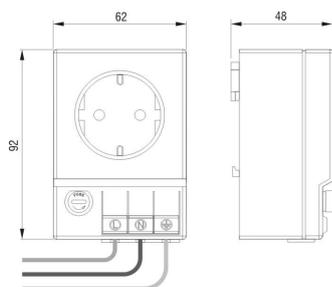
**Anschluss:** 3 x Druckklemmen für Litze und Starrdraht 0,5-2,5 mm<sup>2</sup>
