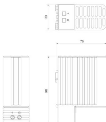
Heizgerät für den Einsatz in kleinen Gehäusen, wenn eine Mindesttemperatur nicht unterschritten werden darf und Kondenswasserbildung verhindert werden soll. Die Heizgeräte sind für den Dauerbetrieb ausgelegt.
